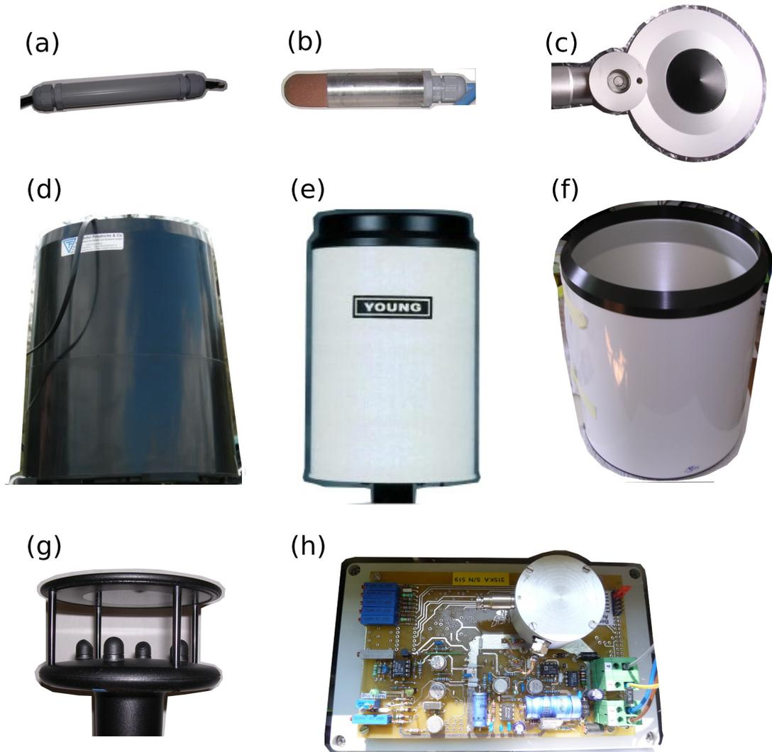
Abbildung 2.6.: Verwendete Sensoren im WegenerNet: (a) Temperatur- und Feuchtesensor, (b) pF-Meter, (c) Netto-Radiometer, (d) Niederschlagsgeber 7041, (e) Niederschlagsgeber 52202, (f) Niederschlagsgeber MR3H, (g) Ultraschallanemometer, (h) Barogeber.
