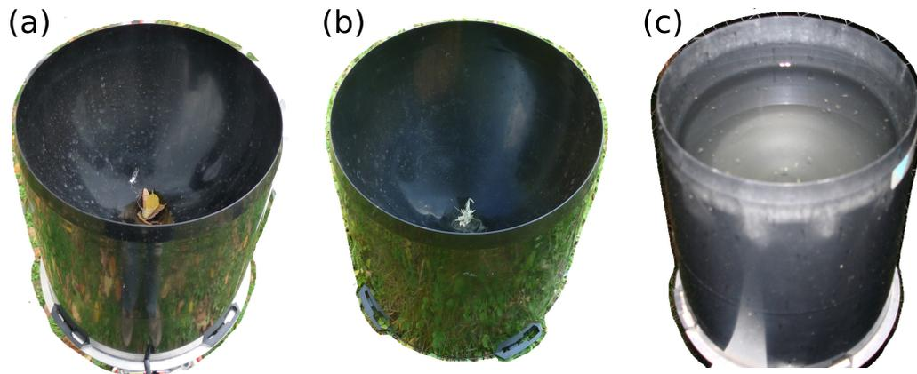
Abbildung 3.15.: Blockierung der Trichteröffnung des Niederschlagsgebers. Schwebeteilchen in der Luft wie (a) Laub und (b) Gräser legen sich innerhalb der Sensorauflagefläche an und führen zu (c) sich ansammelnden Niederschlagsmengen.
